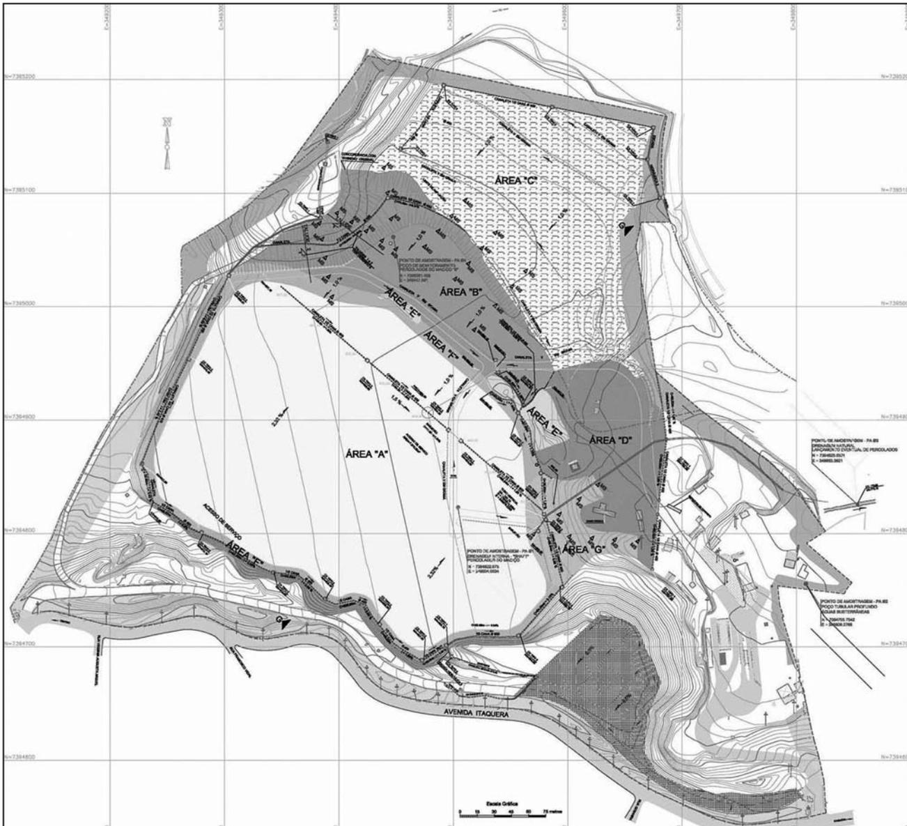
Figura 3. Zoneamento geológico-geotécnico – Mapa das unidades geotécnicas (IPT 2007)
