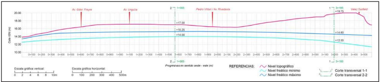
Figura 14. Corredor Bv Pellegrini / Bv Gálvez. Corte longitudinal. Niveles topográficos y niveles freáticos extremos (máximos: 03/03/2016 y mínimos: 17/08/2018).
