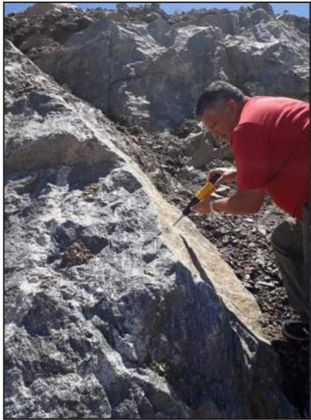
Figura 6. Ubicación del Esclerómetro en el plano.
