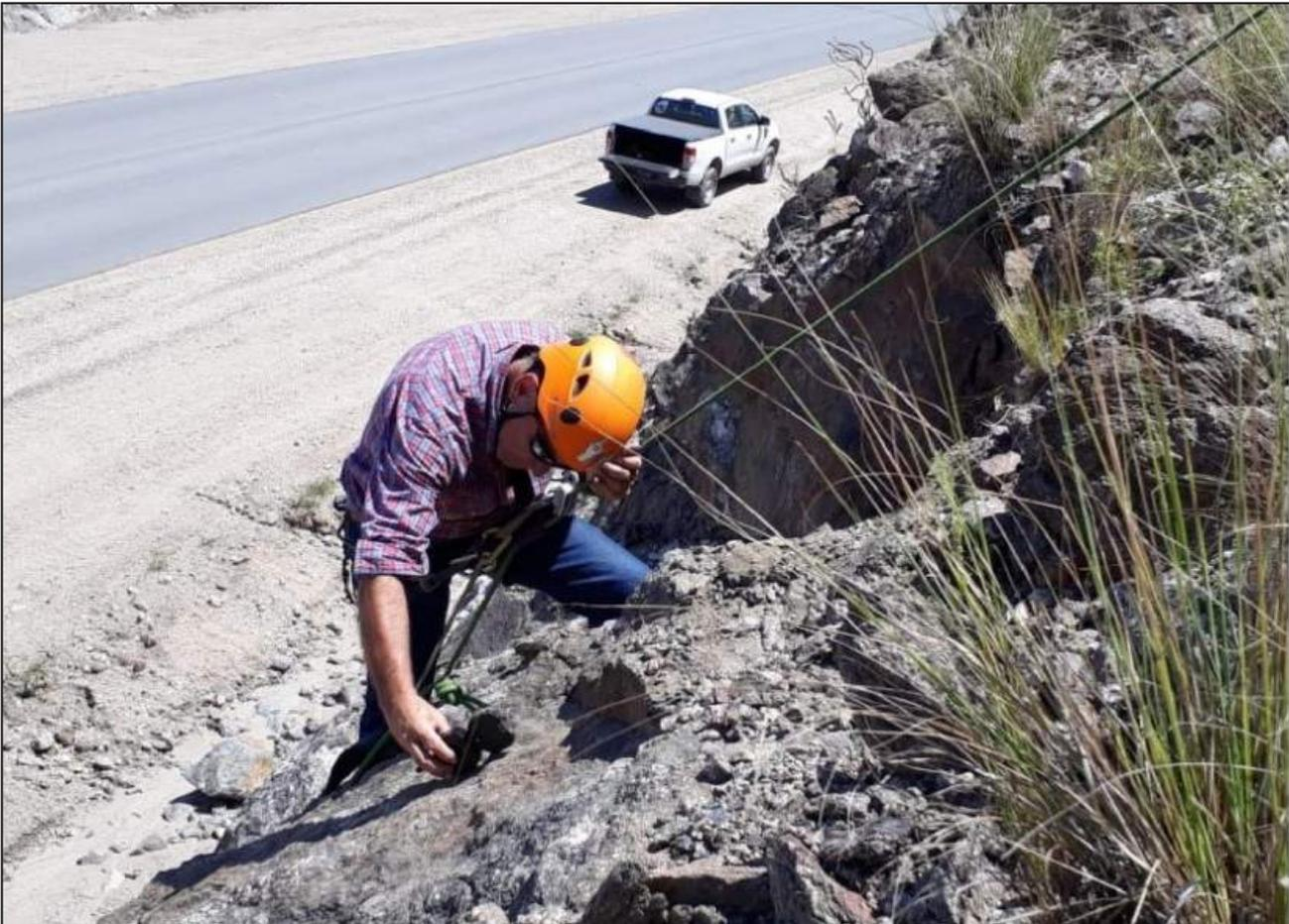
Figura 4. Medición de buzamiento con brújula geológica, en plano de discontinuidad desfavorable a la estabilidad. Toma de datos en EG 23 (31° 31.754 S - 64°30.060 O).
