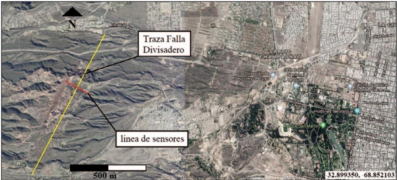
Figura 5. Posición de los puntos de medición de vibraciones ambientales (a lo largo de la línea roja). Los puntos se eligieron a fin de obtener un perfil aproximadamente perpendicular a la traza (línea amarilla) de la falla Divisadero Largo.
