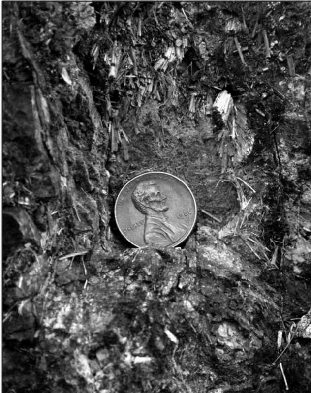
Figura 2. Fibras sueltas de crisotilo en venillas "cross fiber" en mina La Bélgica.
