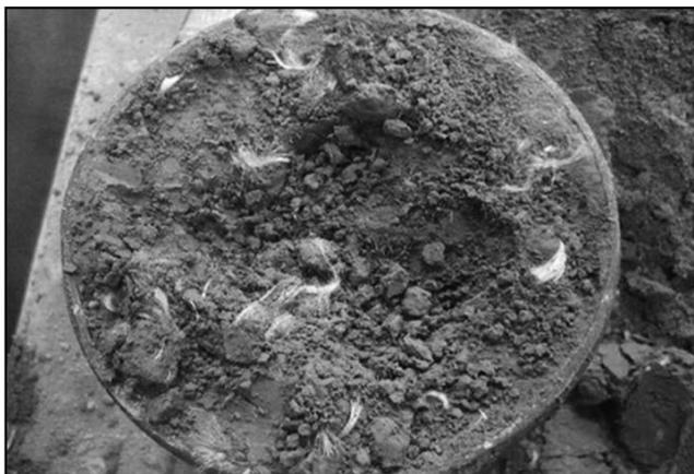
Figura 4. Mezcla de suelo loésico con 7,5% de cemento y 2‰ de fibras.
