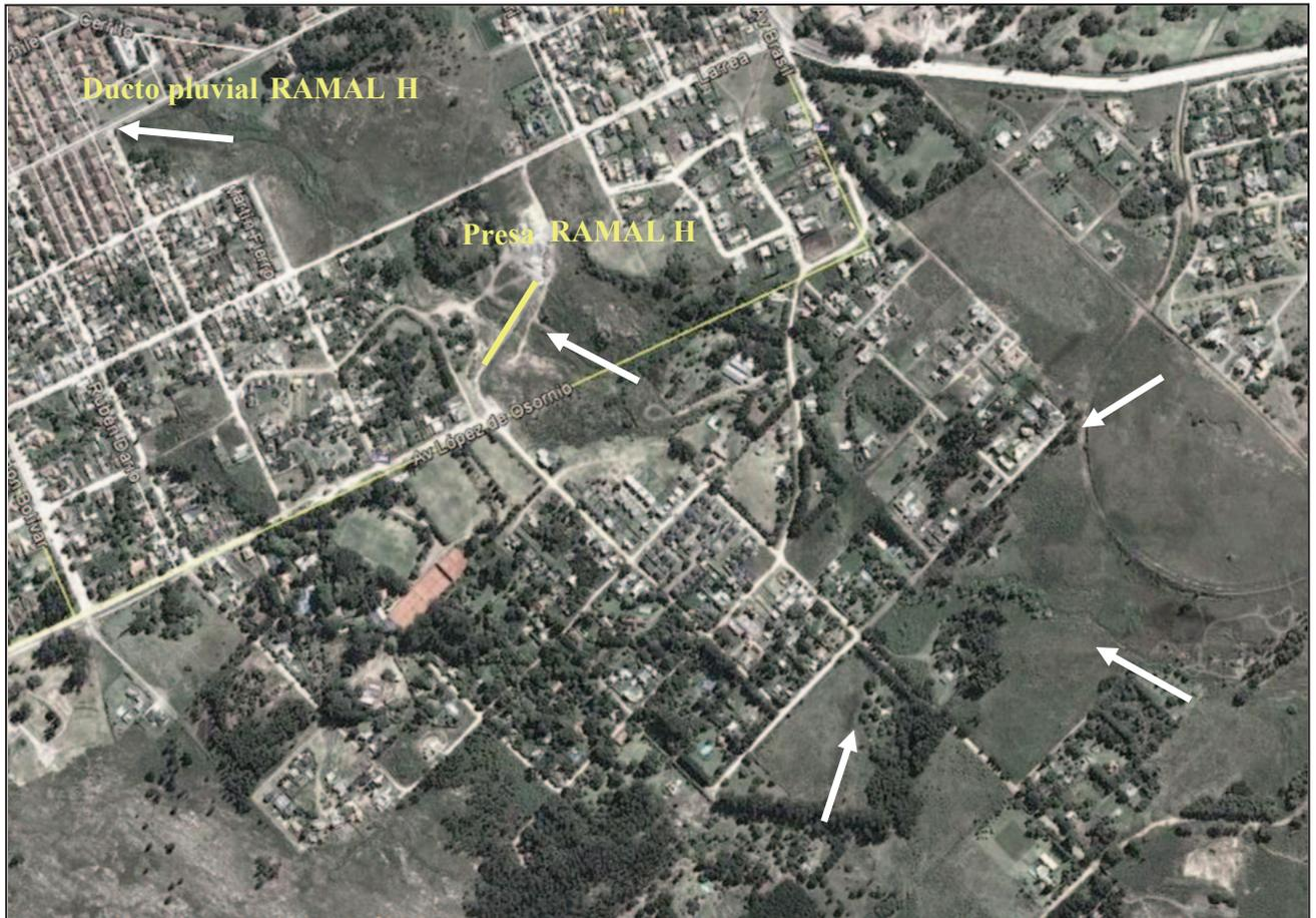
**Figura 2.** Vista general en planta de la cuenca y ubicación de la presa "urbana" Ramal H. Las flechas indican el sentido general del escurrimiento fluvial. La punta de la flecha superior izquierda señala además la entrada al ducto pluvial ramal H.
